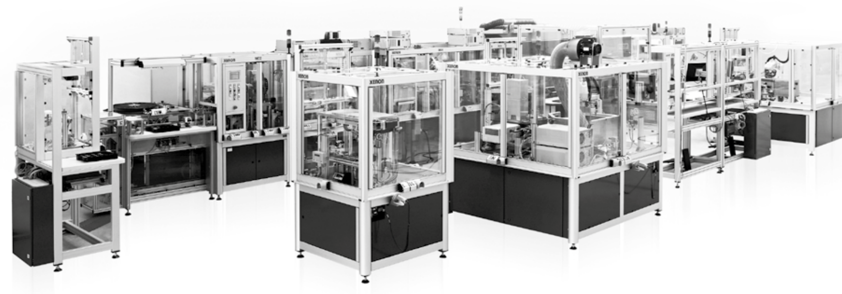
Bild 4: Anlage zur Montage und Prüfung elektroakustischer Wandler, Quelle: XENON Automatisierungstechnik GmbH
