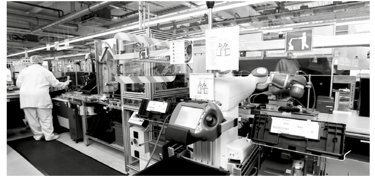
Bild 3: Fertigungslinie mit mobiler Roboterplattform, Quelle: Leopold Kostal GmbH &amp; Co. KG - Standort Halver
