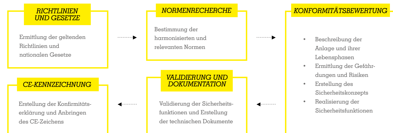
Bild 1: Ablauf der CE-Kennzeichnung in fünf Schritten
