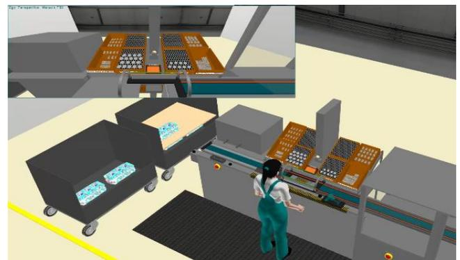
Abbildung 5: Arbeitsprozesssimulation zur Zeit- und Ergonomiebewertung mittels emaWD
